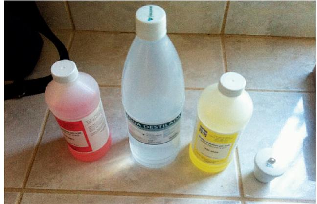
Figura 5.- Calibrados de PH.
