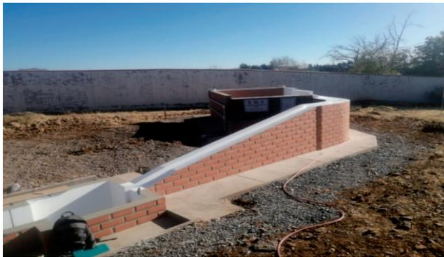
Figura 3 Modelo físico del aliviadero escala 1:30 construido
