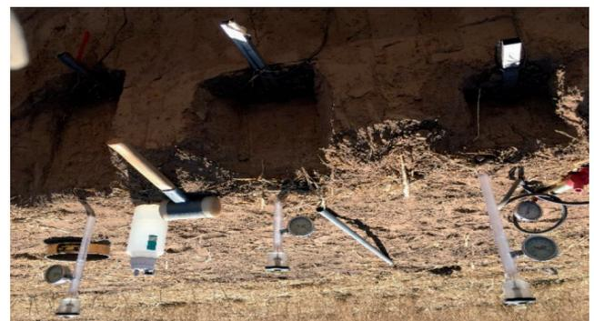
Figura 2. Instalación de células de carga y tensiómetros. Procedimiento de los ensayos de campo
