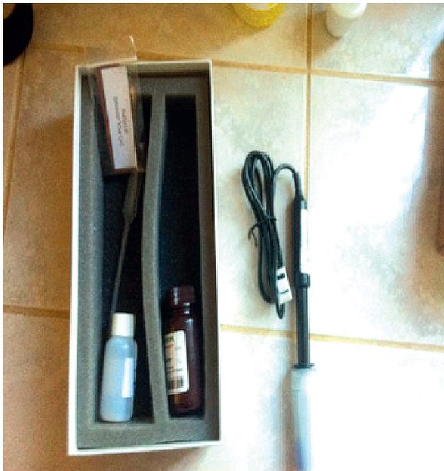
Figura 4.- Calibrados Vernier de oxígeno disuelto.
