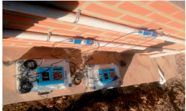
Figura 9 Medidores ultrasónico de flujo TUF-2000P TM
