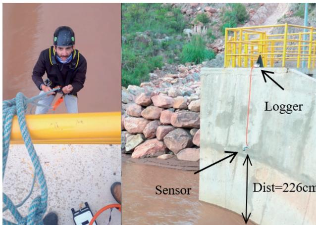
Figura 2 Proceso de instalación de los sensores Arduino.
