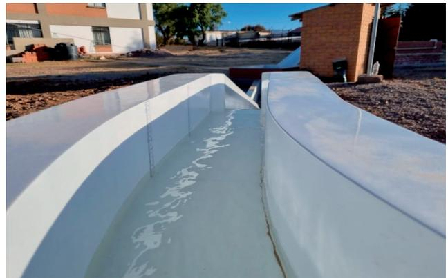
Figura 10 Cintas métricas instaladas para medición de tirantes
