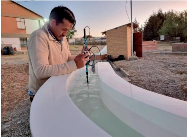
Figura 11 Medición de la velocidad con molinete
